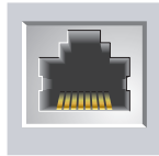
יציאות 1000Base-T Gigabit Ethernet
